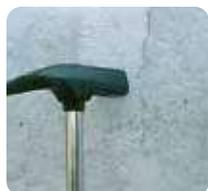
**1** Para morteros de cemento y/o cal, sondear con un martillo las partes accesibles. En particular, las zonas fisuradas, con el fin de comprobar si el mortero suena a hueco.
