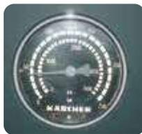
**6** En general, regular la bomba a una presión inicial baja (40 bars). Si es insuficiente, aumentarla hasta 200 bars. A partir de este punto, existe el riesgo de deteriorar el soporte.
