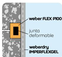
2 Pequeñas fisuras: abrir la fisura (2x1 cm). Colocar una junta estanca y sellarla con **weber FLEX P100**. Dejar secar al menos 3 días y proceder como con las microfisuras.
