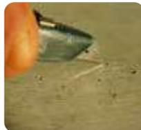
4 Sobre soportes pintados, efectuar el test de la cuadrícula, cortando la película de pintura con un "cutter" o cuchillo.
