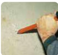
3 Verificar igualmente la dureza en todo su espesor, sobre todo en suelos antiguos. Eliminar la capa falsamente dura producida por una lechada superficial.
