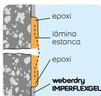
3 Fisuras grandes: limpiar y desengrasar. Dejar secar. Colocar una cinta adhesiva sobre la fisura, aplicar una cola epoxi y retirar la cinta, colocar una lámina de estanquidad y recubrirla con **weberepox EASY** (pág. 184).
