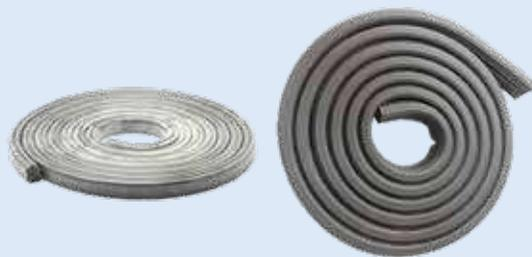
Las juntas de impermeabilización **weberdry** están compuestas por bentonita (una arcilla natural), incrustada en una matriz de caucho de butilo de alto peso molecular, así como rellenos especiales y mezclas cristalinas. La bentonita tiene la propiedad de aumentar rápidamente su volumen por hinchamiento, cuando entra en contacto con el agua. Presentan un rendimiento de hinchamiento fuerte, rápido y estable.
