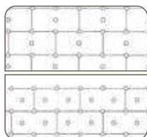
2 Realizar el refuerzo del anclaje de las placas al cabo de 24 horas mínimo, colocando tacos de plástico expansivos con un diámetro mínimo de cabeza circular de 60 mm, en cantidad no inferior a 6 unidades por m<sup>2</sup>. En placa de LM se recomienda colocar la espiga a 150 mm del borde de la placa.
