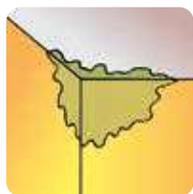
Se produce cuando el vapor de agua existente en el interior de un local (cocinas, habitaciones, etc.) entra en contacto con superficies frías (cristales, metales, paredes, etc.), formando pequeñas gotas de agua. Este fenómeno se suele dar en invierno y favorece la creación de microorganismos que son perjudiciales para la salud, alterando la estética del local. Es fundamental la utilización de productos permeables y tener buena ventilación para evitar este problema.
