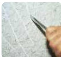
3 Si el destornillador penetra ligeramente el mortero no es duro, pero está suficientemente cohesionado. Si el destornillador entra con profundidad, hay que eliminar todo el mortero.
