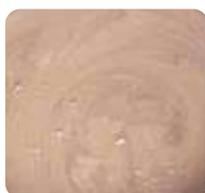
3 Hay que respetar las cantidades de agua al amasar. Si aparece espuma superficial, es un indicio de exceso de agua y la pasta perdería dureza, y por tanto, resistencia para la colocación de un revestimiento.
