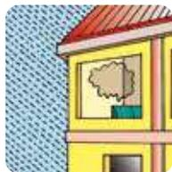
Es un tipo de filtración producida por el agua de lluvia, que penetra directamente por la fachada y/o cubierta del edificio como consecuencia de una deficiente impermeabilización.
