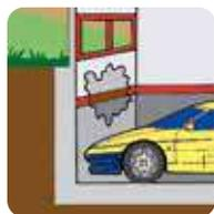
Es aquella causada por la penetración directa del agua en el interior de los edificios a través de sus muros. Es muy frecuente este tipo de humedades en sótanos enterrados que se encuentran por debajo del nivel freático.
