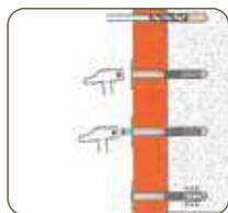
1 Deben utilizarse **webertherm espiga** (pág. 138) complementarias al encolado con **webertherm BASEGEL**, tanto en obra nueva como rehabilitación, incrementando el número por m<sup>2</sup> en rehabilitación y zonas expuestas a condiciones severas.
