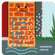
Es la que aparece en las zonas bajas de los muros que absorben el agua del terreno a través de la cimentación. La humedad de remonte capilar puede ser permanente cuando el nivel freático del terreno está muy alto, cuando está relacionada con las condiciones meteorológicas (suele aparecer en invierno y secarse en verano).
