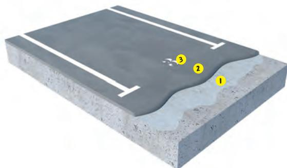
Sistema de regularización y nivelación industrial de alta resistencia a la abrasión
