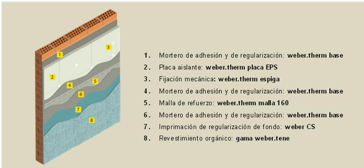
Figura 1: Componentes del sistema weber.therm etics, acabado acrílico
