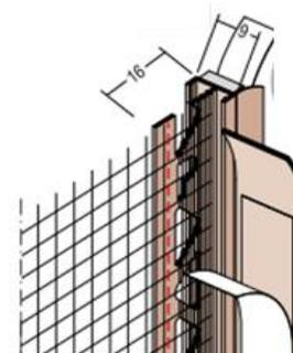
**Descripción** **weber.therm perfil remate ventana** es un perfil de PVC con autoadhesivo para el remate de ventanas, con aletas flexible recubiertas de autoadhesivo para la colocación de un film protector de la ventana durante los trabajos; además cuenta con malla de fibra de vidrio de 4x4 mm para hacer el solape con la capa de regularización del SATE.
