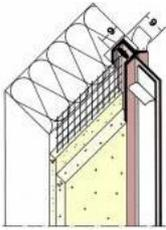
Retirar el protector del autoadhesivo, y colocar el perfil pegado al marco de ventana una vez haya sido colocado el aislante. Adherir la malla del perfil con **weber.therm base** al aislante, y solapar la malla de refuerzo de todo el sistema con el mismo mortero regularizador.
