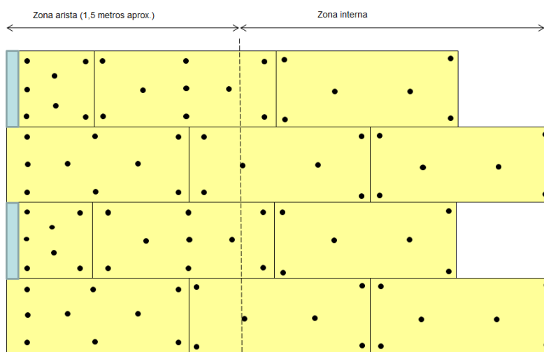
Colocación espigas en arista vertical de edificio: altura superior a 20 metros
