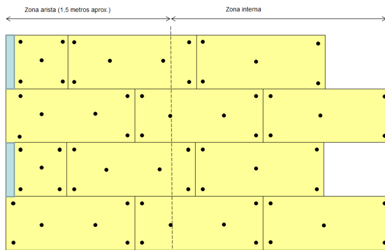
Colocación espigas en arista vertical de edificio hasta altura de 8 metros
