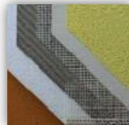
Malla constituida por hilos de fibra de vidrio con doble torsión y tratamiento de resina que las protege del ataque a los álcalis de los materiales cementosos. Confieren resistencia y estabilidad al revestimiento, evitando la aparición de fisuras debidas a las variaciones de temperatura y del movimiento de las placas de aislamiento. Además la malla contribuye a la mejora del comportamiento a la resistencia al impacto del revestimiento donde esté incorporada.
