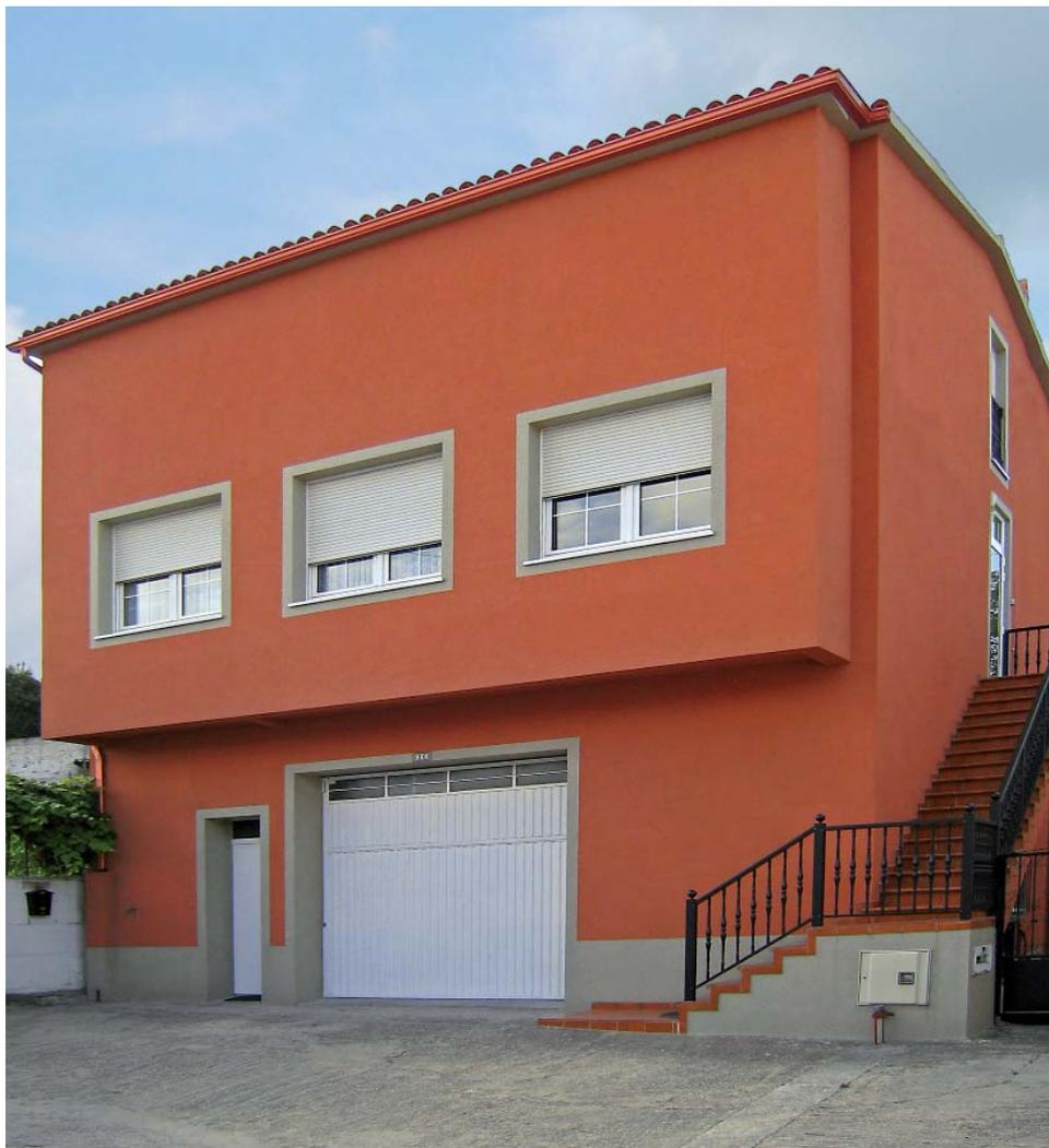
**Obra:** Casa unifamiliar / **Localización:** Ctra. Pocomaco, nº 26. El Birloque. La Coruña / **Superficie aplicada:** 250 m<sup>2</sup> / **Año finalización:** 2009 / **Sistema de revestimiento:** sistema **weber.therm etics** revestido con **weber.tene** ladrillo, acabado fratasado
