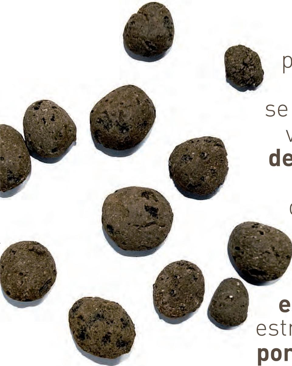
La **arcilla expandida** se produce a partir de arcillas que se formaron hace varios **millones de años**. A través de un proceso de **granulación y expansión** se transforma en **pequeñas esferas** con una estructura interior **porosa** y una **dura corteza** externa.
